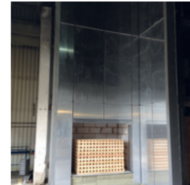
테스트 설정-카세트에 알루미늄 고리가있는 Kingspan BENCHMARK 외관 패널
