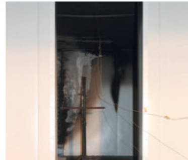
내부 손상이 제한적이며 플래시 오버 상태의 증거가 없는 테스트 종료
