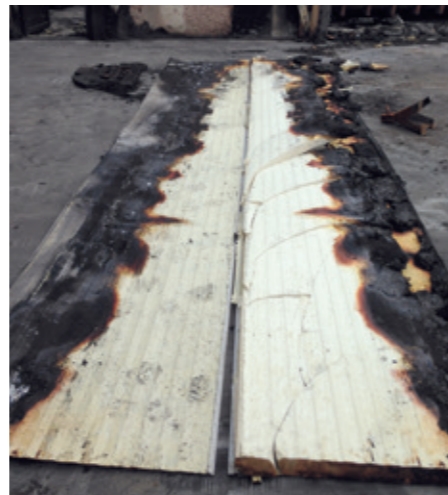
PIR 코어의 탄화를 보여 주지만 강철이 벗겨진 접합부의 패널은 화재 확산의 증거가 없습니다.
