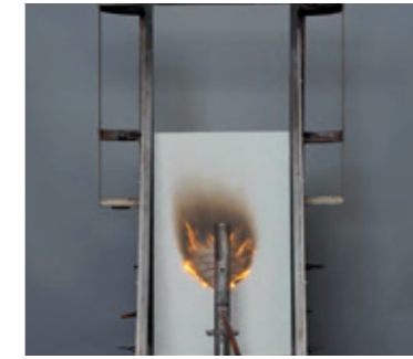
3 분간의 테스트 진행-표면 연소 및 연기 배출 부족에 주목
