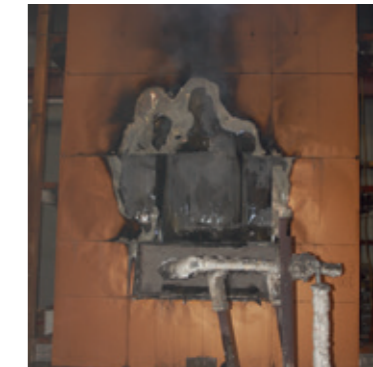
Kingspan 절연 금속 패널이 손상되지 않은 상태에서 ACM 레인 스크린의 손상을 보여주는 테스트 종료
