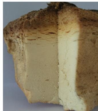
C: 지붕의 구멍을 덮는 임시 지붕. D: 박리된 하부 표면 및 관통 두께 숯의 정도를 나타내는 PIR 코어. E: 샌드위치 패널의 하부 스틸 스킨 가장자리를 자릅니다.
