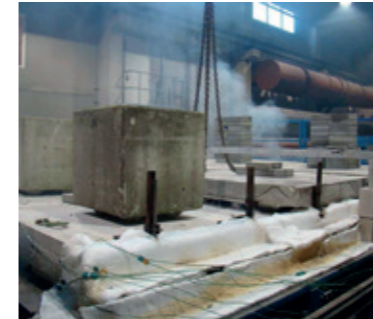
1 시간 후 Op-Deck은 절연성, 완전성 및 하중지지 능력의 장애가 없음을 보여줍니다.
