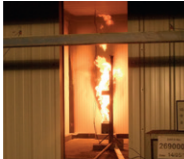
진행중인 테스트-버너가 수직 패널 조인트에 인접해 있음
