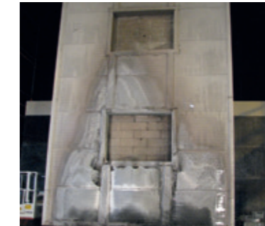
클래딩으로 인한 최소한의 화재 확산을 보여주는 테스트 후 외관
